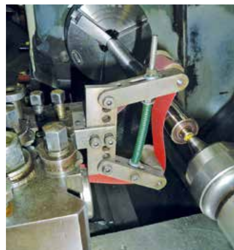
↑ FIGURE 2 Tour conventionnel avec dispositif de toilage.
