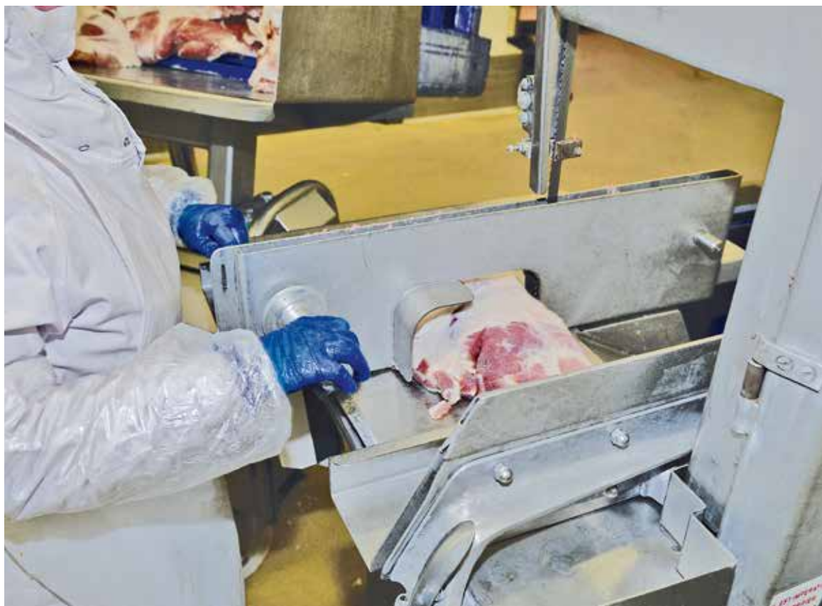
Une scie à ruban sécurisée utilisée pour la découpe de viande de porc.
