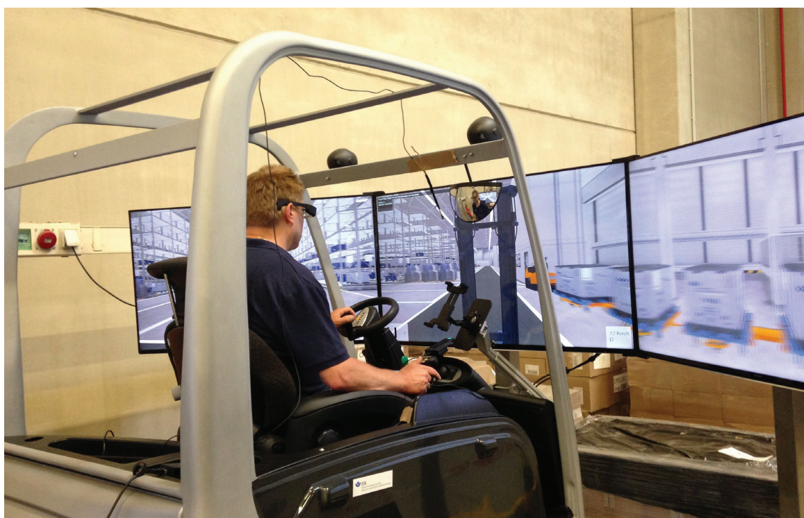
Projet de recherche IFA/BGHW sur les risques liés à l'utilisation des lunettes connectées lors de la conduite de chariots de manutention.
