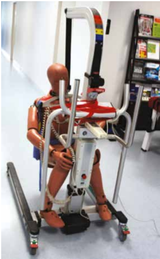
↑ FIGURE 1 Lève-personne équipé de la poignée de mesurage des forces de tirer-pousser et d'un mannequin de test.
