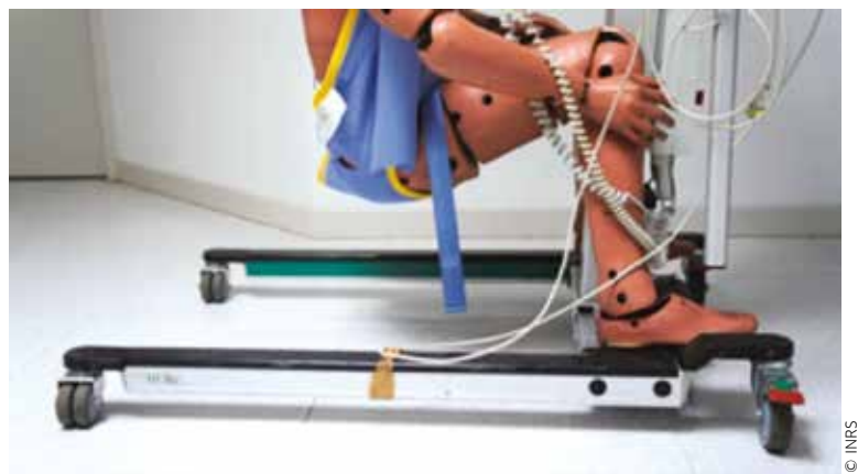
↑ FIGURE 2 Orientation des roulettes du lève-personne pour les essais.
