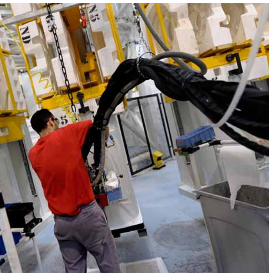
Carrousel automatisé d'injection de mousse isolante
